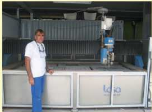
L'unité de découpe par jet d'eau très haute pression
